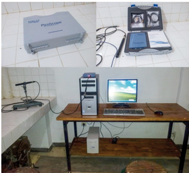
Photo 2. Dispositif de caractérisation mécanique du bois. Photo M. C. Hounlonon.
