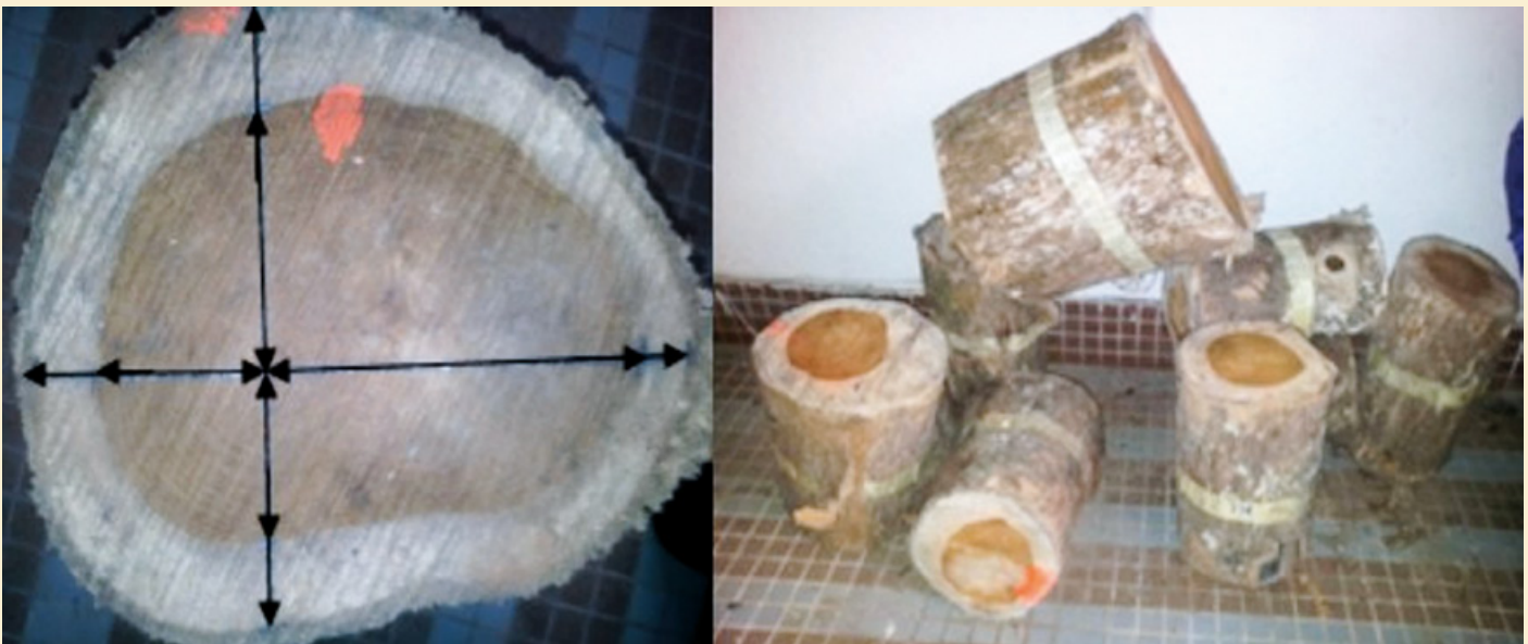
Photo 1. Rondelles de teck montrant les rayons pour la détermination du pourcentage de bois de cœur. Photo M. C. Hounlonon.
